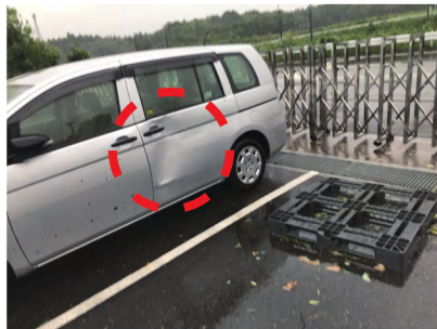
パレットが飛び車が破損
